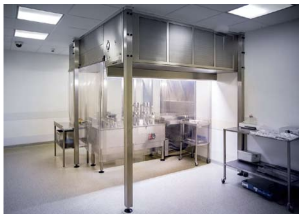
▲ Urządzenie do napełniania produktów leczniczych i kontroli ich szczelności
